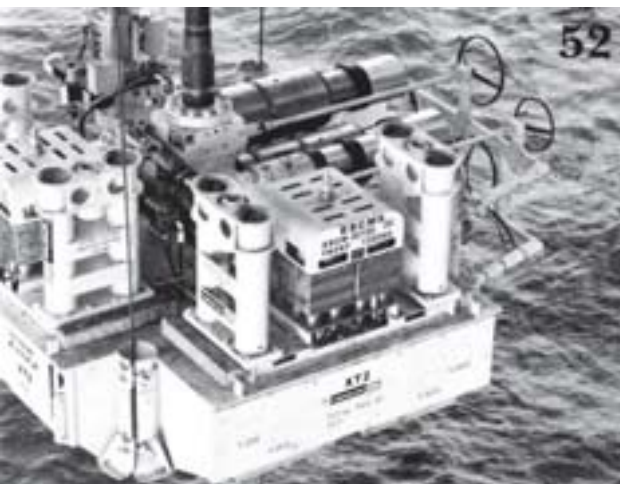
لوله جدید جایگذاری می شود فشار بالا برده شده و به تسمه حفاری متصل می شود.
